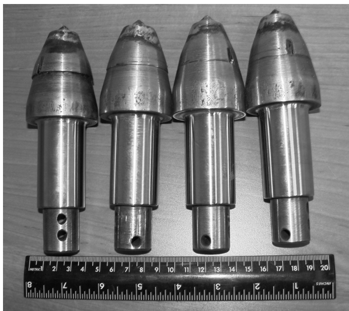
Рис. 2. Универсальные резцы РГП многоразового применения на шахтном комбайне
