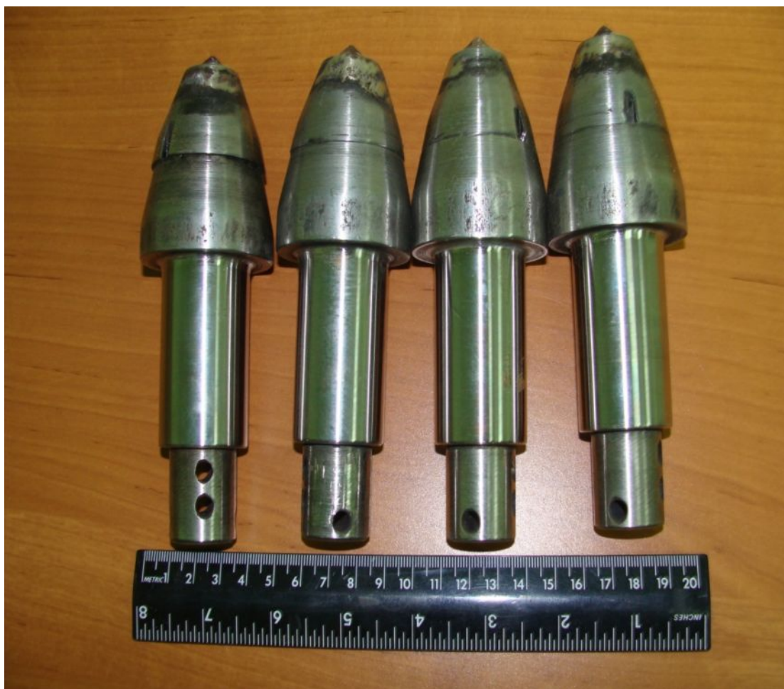
Рис. 2. Универсальные резцы РГП многоразового применения на шахтном комбайне
